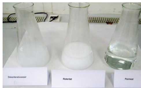
Effizienz des Filterprozesses (links Wasser direkt aus der PVC-Produktion, Mitte Retentat (konzentriert), rechts gefiltertes Wasser)
